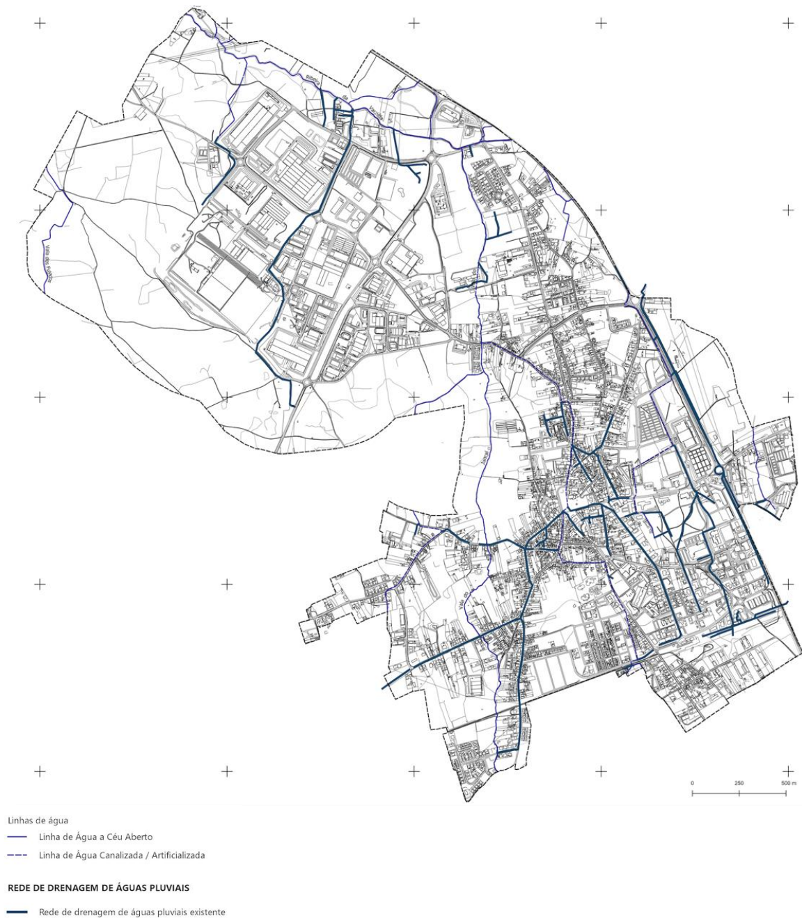
Figura 21 - Rede de drenagem de águas pluviais existente
