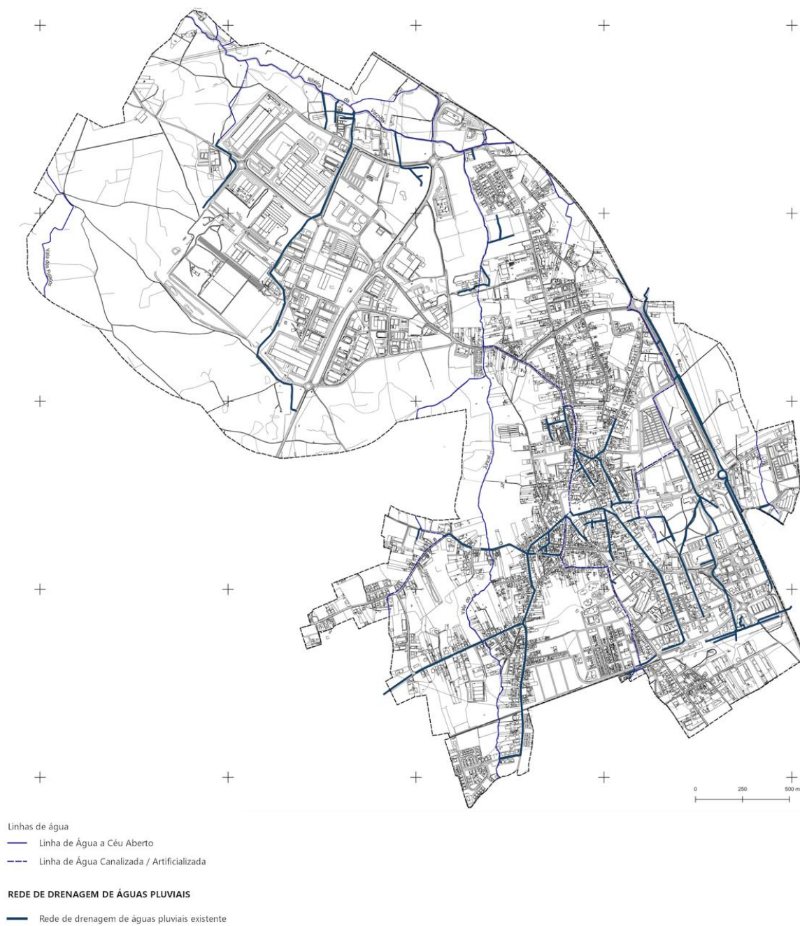
Figura 20 - Rede de drenagem de águas pluviais existente
